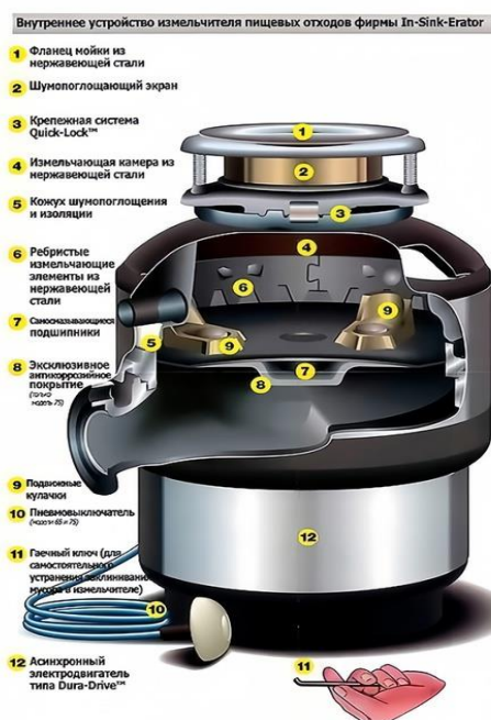
Рисунок 1 – Устройство диспоузера
